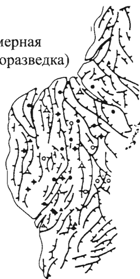
Рис. 123. Уточнение структурной модели по мере получения более подробных сейсмических данных. Сравнение структурных карт блока IV месторождения Cormorant в Северном море у берегов Великобритании [79]
