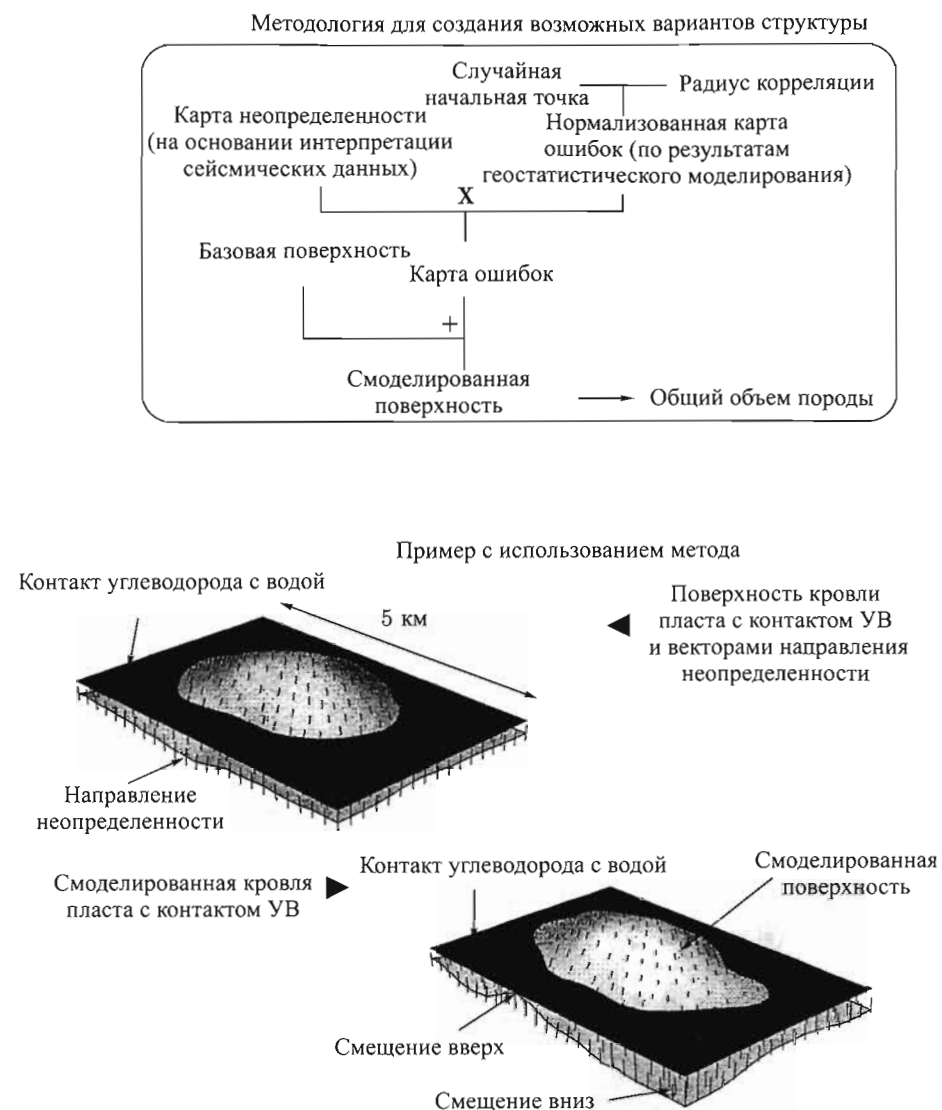
Рис. 84. Простой метод создания карты в пределах некоторого диапазона неопределенности [31]
