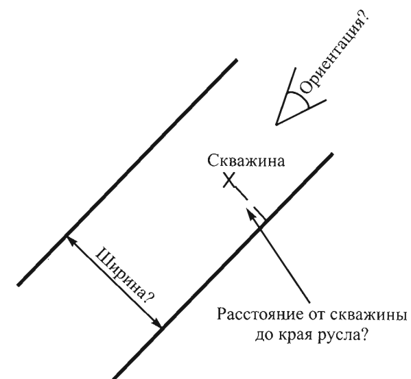
Рис. 19. Ключевые элементы неопределенности в пространстве вокруг скважин при построении объектно-ориентированной модели
