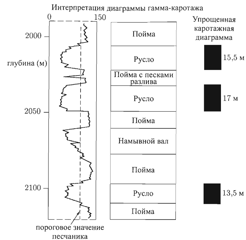
Рис. 18. Создание упрощенной каротажной диаграммы для объектно-ориентированного моделирования
