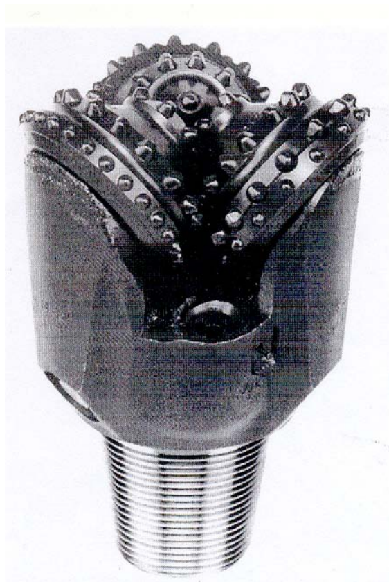
Рисунок 3.70б – Общий вид современного трехшарошечного твердосплавного долота
