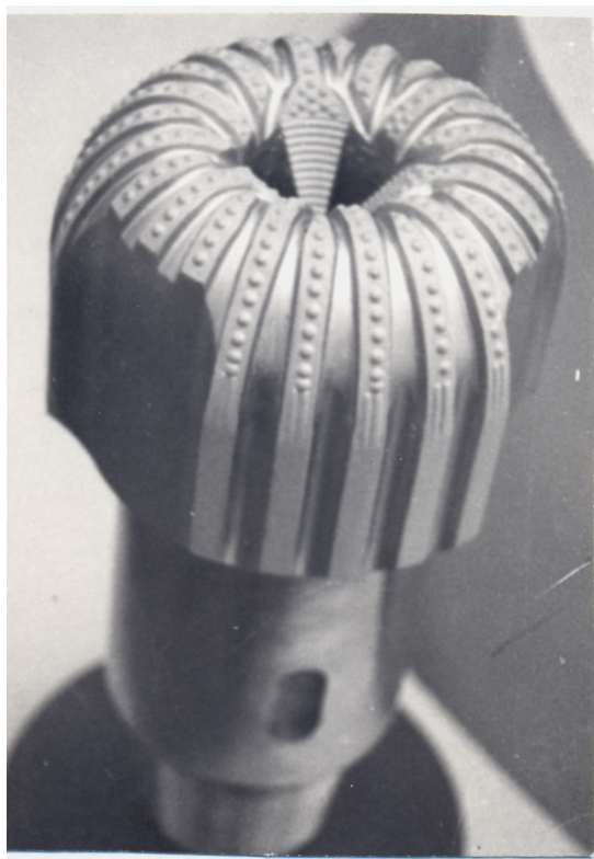
Рисунок 3.21 - Долото типа ДР новой модификации
