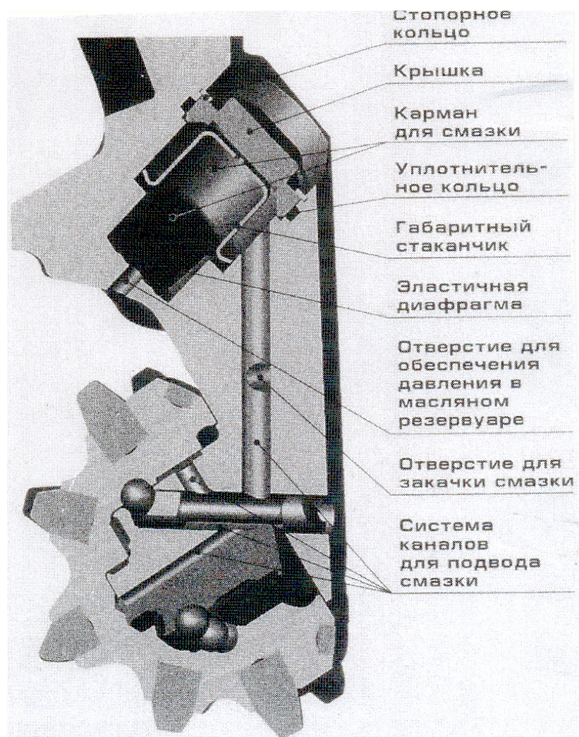
Рисунок 3.84а – Устройство долота с новой схемой лубрикатора
