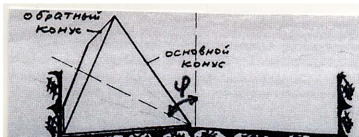
Рисунок 3.60 - Первое одноконусное шарошечное долото
