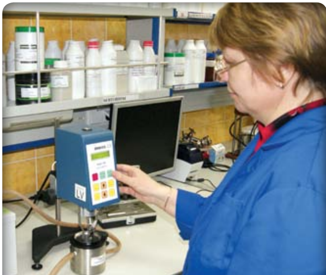
Определение реологических параметров при низких скоростях сдвига
