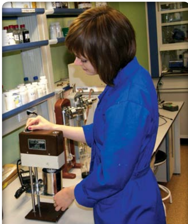
Измерение реологических параметров 8-скоростным вискозиметром OFITE 800
