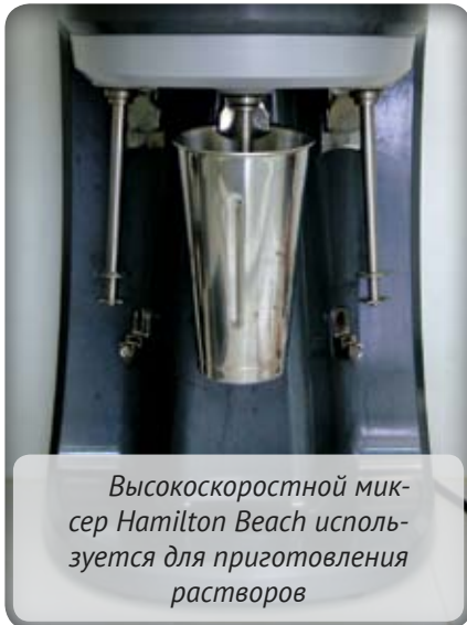
Приготовление диспергированной бентонитовой суспензии
