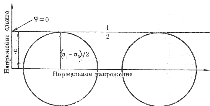
Рис. 8.11. Диаграмма Мора для нелигифицированной глины. Угол внутреннего трения \varphi равен нулю в сильно пластичном материале. Разрушение происходит, когда \sigma_1 - \sigma_3 в 2 раза больше прочности сцепления c :
